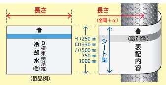
シート上には方向矢印と流体名、識別色の帯が表記されます。 ご指定いただくフィットシートの寸法は、表記内容に適した シート幅(=5種類から選択)と、配管円周に保温材の厚みや 重ねしろを加えた「巻き付け方向の長さ」の2点です。 ご指定の文字内容を、このシート幅に合わせた適切な大きさ で表記してお届けいたします。(裏面の用紙をご活用下さい。)
